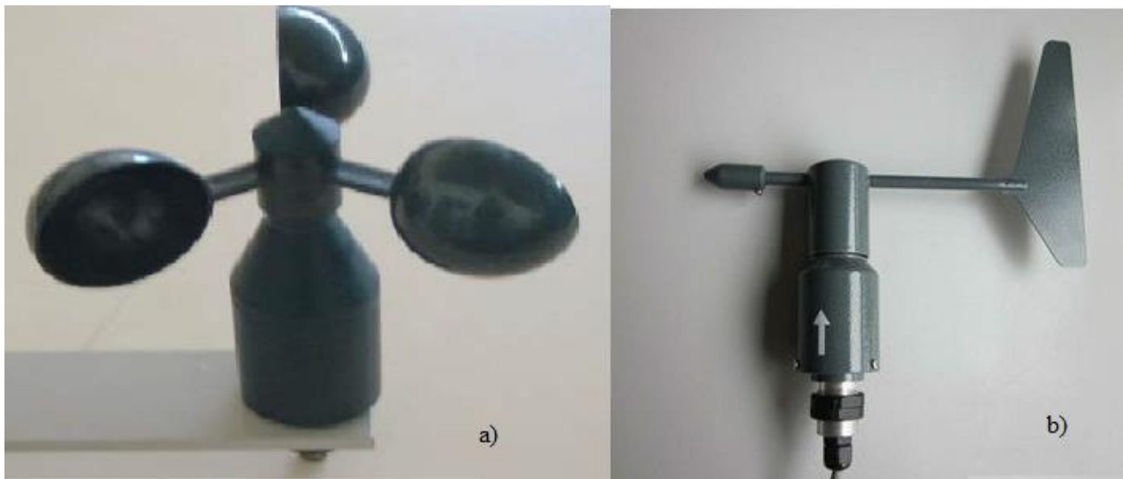
Figura 2. 4: Instrumentos de medição do vento: a) Anemómetro de três conchas e b) Cata-vento de palheta. (Fonte: Rújula, 2012)
