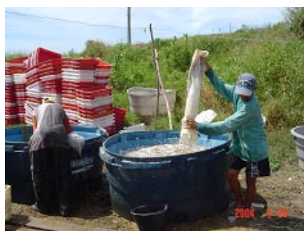
Fig. 26. Manipulação da solução de metabissulfito sem EPI.
